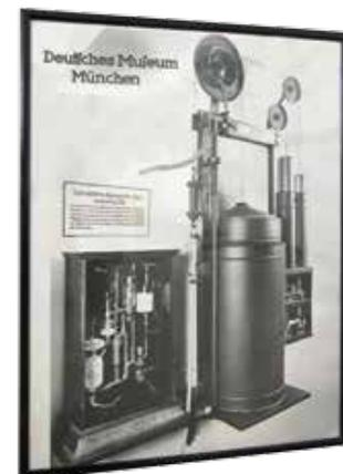
Primer comprobador automático de gases de combustión "ADOS" del año 1900. Accionado por el tiro de la chimenea, el aparato realiza 10 veces por hora una prueba de los gases de combustión, la analiza automáticamente e indica su contenido de gas ácido carbónico. Este es el indicador para el aprovechamiento óptimo del combustible por parte de los fogoneros. Se sitúa en un 15 % de contenido de gas ácido carbónico en los gases de hogar.
