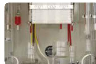
Aparato de medición triple (Triplex) para la supervisión del nivel de CO, H2 y CO2 en el aire ambiente – Uso en la industria química.
